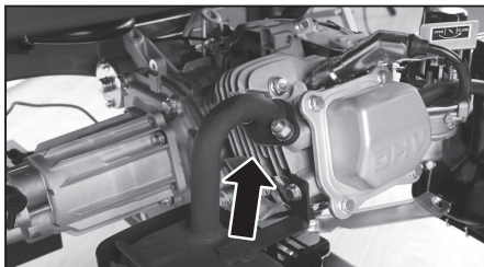
Žebra chlazení motoru, Obr. 24
